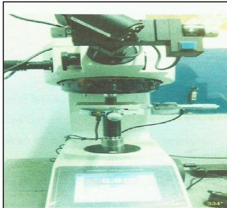
Gambar 4 : Mesin Uji *Vickers*
